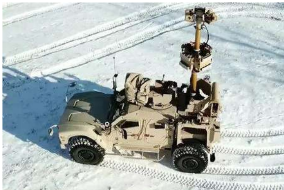
Мобильный комплекс РЭБ Anti-UAV Defence System.
