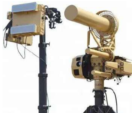
Мобильный комплекс РЭБ Anti-UAV Defence System.
